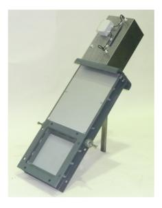
Der **Flachschieber TYP MF** wird an Silo- und Behälterausläufen eingesetzt. Er garantiert optimale Abdichtung bei Lagerung von staubhaltigen oder granulatförmigen Schüttgütern bis 8 mm Körnung.
