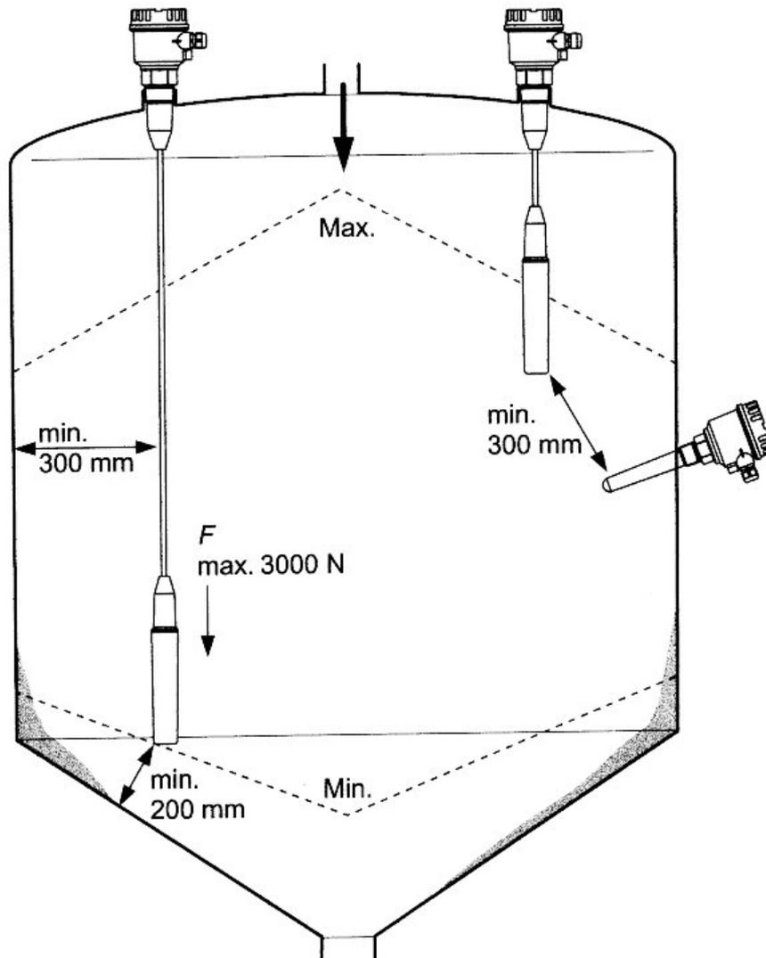
Bei Berechnung der erforderlichen Seillänge, ist der Böschungswinkel des Schüttkegels oder des Abzugstrichters zu berücksichtigen.
