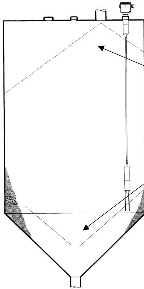
Bei Berechnung der erforderlichen Seillänge, ist der Böschungswinkel des Schüttkegels oder des Abzugstrichters zu berücksichtigen.
