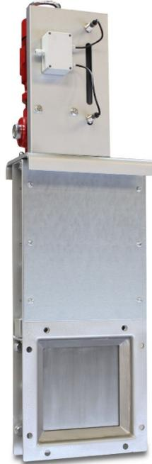
Der **Flachschieber TYP SMFS** wird an Silo- und Behälterausläufen eingesetzt. Er garantiert optimale Abdichtung bei Lagerung von staubhaltigen oder granulatformigen Schüttgütern bis 8 mm Korngröße. Der modular aufgebaute Schieber ermöglicht bei gleichem Grundrahmen den Anbau der verschiedenen Antriebsarten Hand-, Pneumatik- und Elektromotorischen Antrieb.
